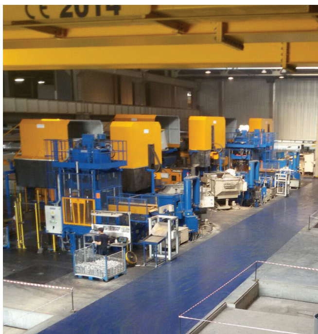
Campanas de dos partes en máquinas de fundición a presión COLOSIO PFO de diferentes tonelajes conectadas a un sistema de aspiración y filtración centralizado ENERPROG - Rusia
