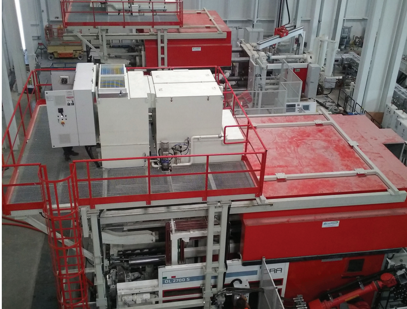
Campanas en dos partes completas con sistemas de aspiración y filtración ENERPRESS individuales para la recirculación del aire depurado en el medio ambiente en máquinas de fundición a presión IDRA OL4200S y OL2700S - EE. UU.
