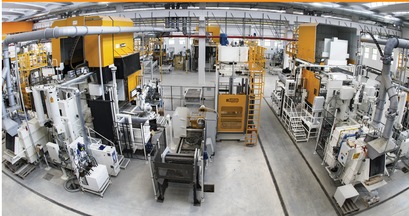
■ Máquinas de fundición a presión con campanas completas de filtros ENERPRESS, ventiladores de aspiración y chimeneas de expulsión individuales – Italia
