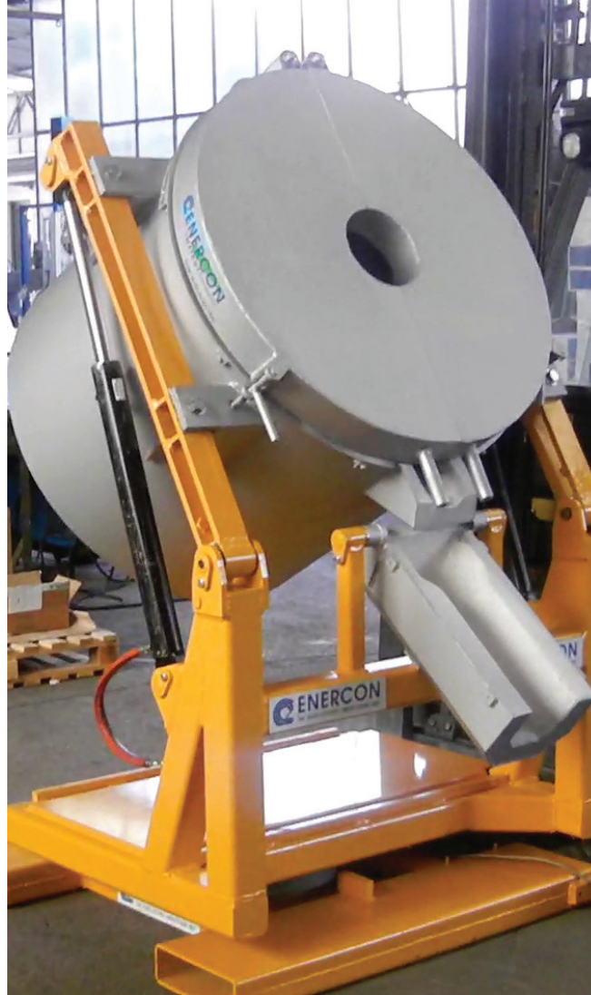
■ Cuchara giratoria y basculante para el transporte y el vertido de 800 kg de aluminio - Italia
