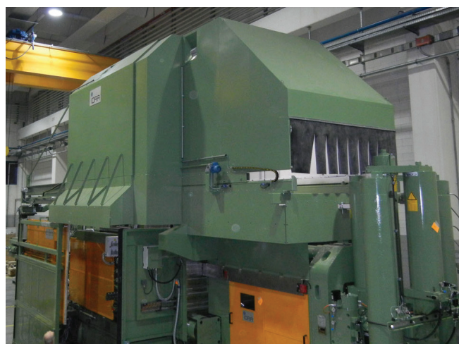
Campana en inyectora Idra conectada al sistema de aspiración y filtración centralizada ENERPRESS - Italia
