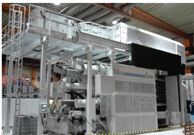
Campana de dos partes compuesta de sistema de aspiración y filtración ENERPRESS individual para la recirculación de aire depurado en un entorno de máquinas de fundición a presión IDRA OL3700CS - Suecia
