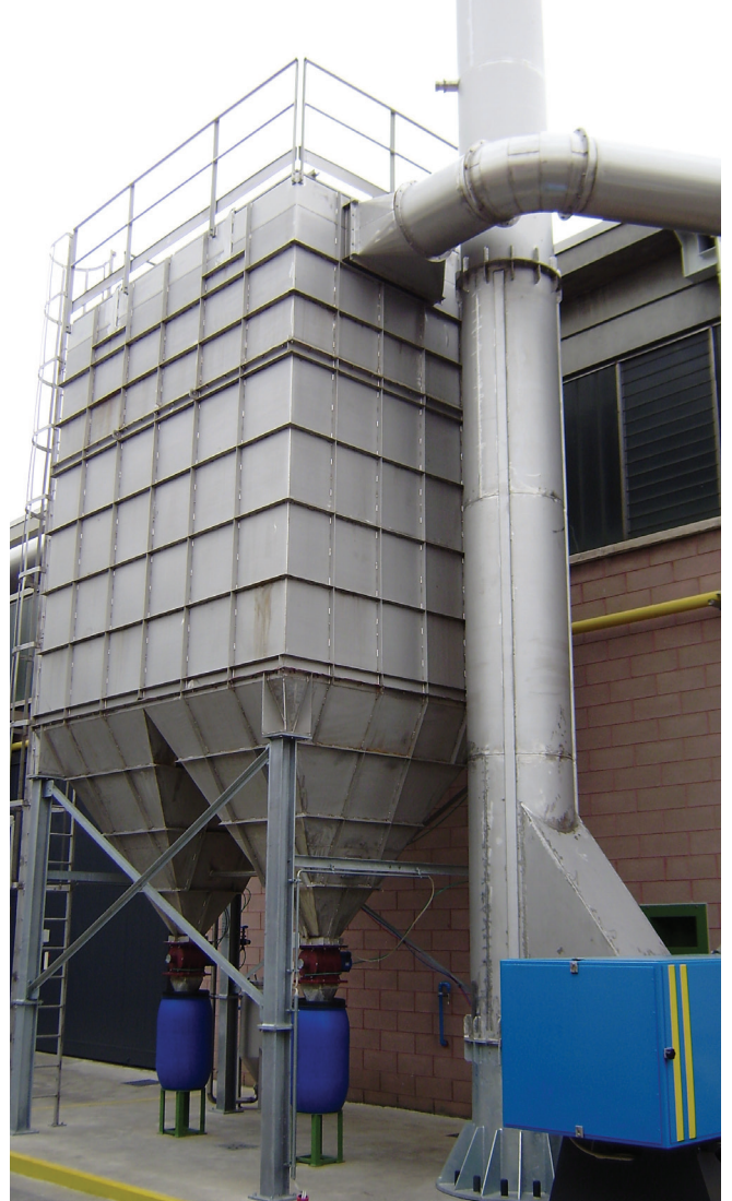
■ Instalación de aspiración y filtración de polvo de bronce. Italia
