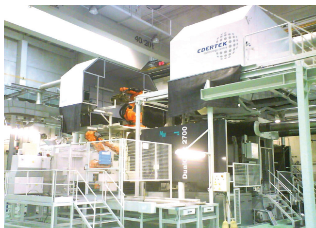
Campana de dos partes en máquina de fundición a presión FRECH DUALCAST 2700 conectada a un sistema de aspiración y filtración centralizado ENERPROG.
