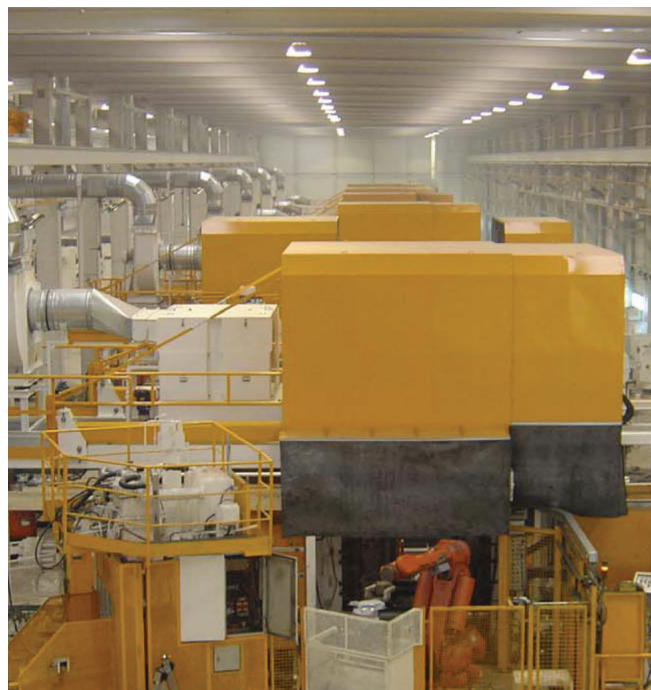
■ Máquinas de fundición a presión con campanas en dos partes con filtros ENERPRESS, ventiladores y chimeneas individuales para la expulsión de aire depurado a la atmósfera - España
