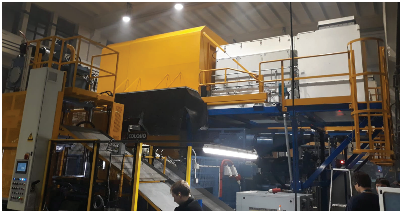
Campana en dos partes completa con sistema de aspiración y filtración ENERPRESS para la recirculación de aire depurado en una máquina de fundición a presión COLOSIO PFO1000 - República Checa
