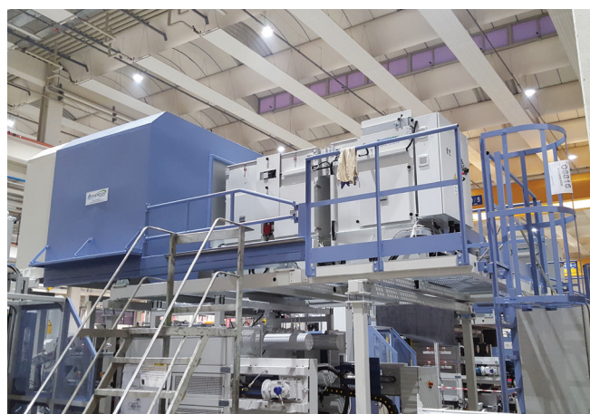
Campana de dos partes compuesta de sistema de aspiración y filtración ENERPRESS individual para la recirculación de aire depurado en un entorno en una máquina de fundición bajo presión IDRA OL420S - Polonia
