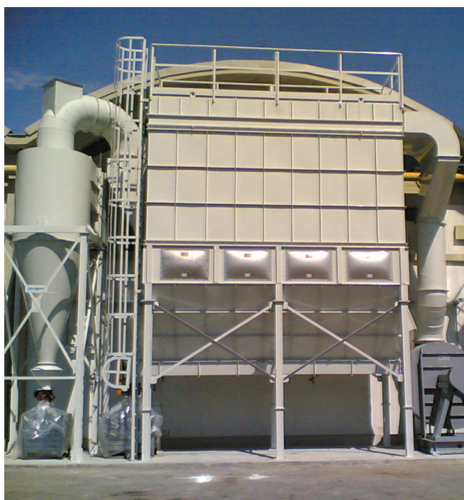
■ Sistema de extracción y filtración para polvos de procesamiento mecánico - Italia
