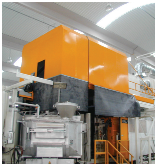
Campana de dos partes con sistema de filtración ENERPRESS, ventilador y expulsión individual a la atmósfera en una máquina de fundición a presión ITALPRESSE IP1650 - España
