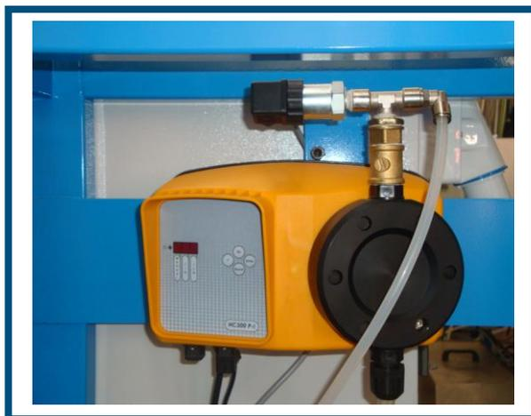
In uscita dal sistema è installato un flussometro di alta precisione (fino a 3 millilitri) per controllare l'invio di prodotto al lubrificatore.
