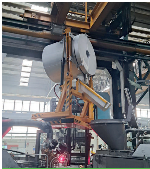
Siviera ruotante e ribaltabile per il trasporto e versamento dell'alluminio da 800 kg – Italia
