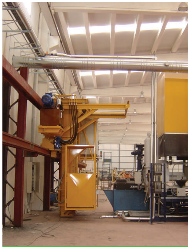
■ Carro siviera per il versamento dell'alluminio automatizzato all'interno dei forni di attesa a servizio delle macchine di pressofusione – Spagna
