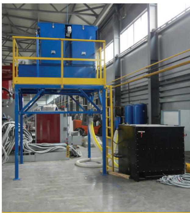
■ Filtro ENERPRESS su struttura indipendente con vasca di lavaggio mobile a fianco, dedicato a singola macchina di pressofusione e collegato ad aspirazione centralizzata. Ucraina
