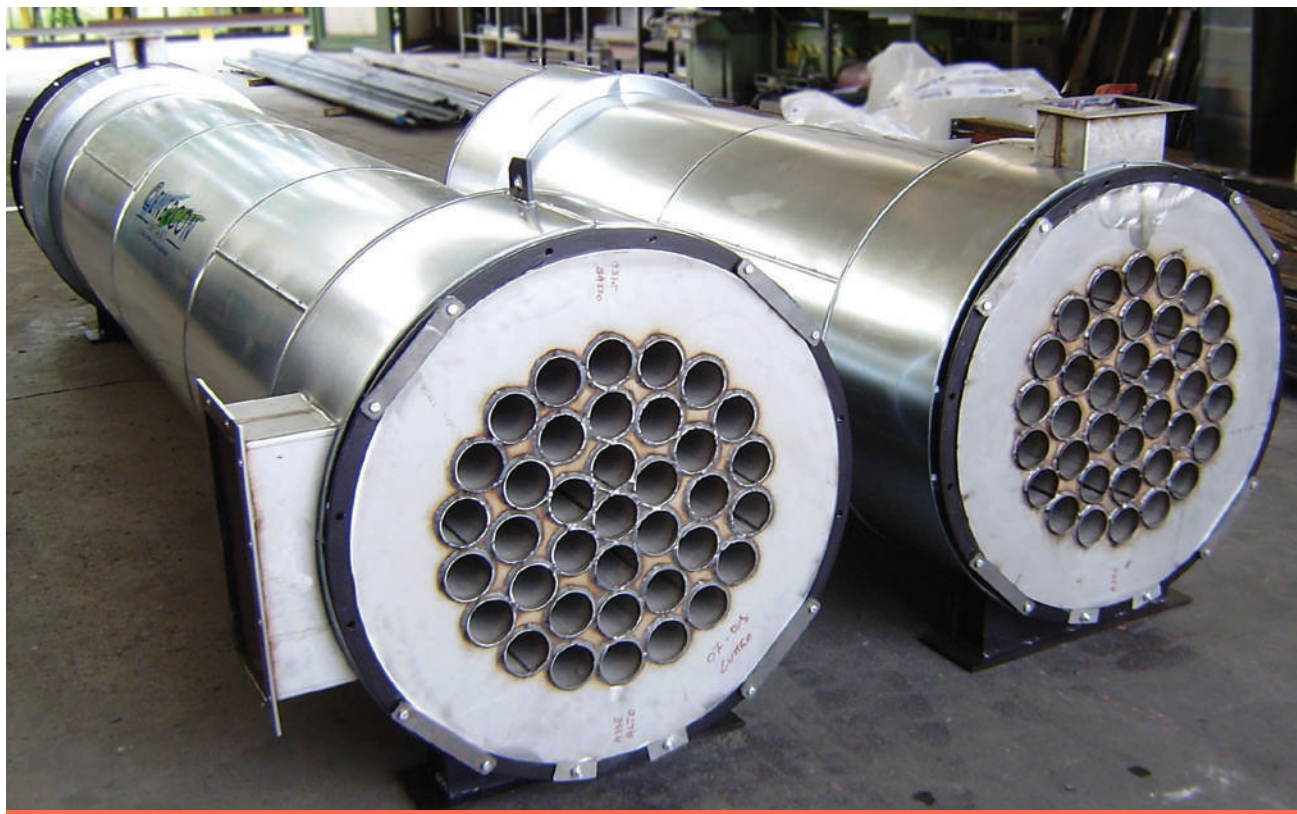
■ Scambiatore di calore a fascio tubiero fumi/aria per preriscaldamento aria comburente prima di immissione nel forno – Italia
